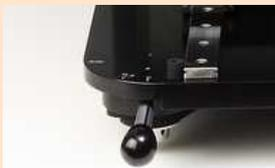
レバーの操作により、3段アクションのZドライブが可能です。アライン（位置合わせ）はウエハーから約300μm針を離して行うので、顕微鏡の焦点からはずれないでステージが移動でき、かつローディング/アンローディングのときは、5.0mm離れますので安全に操作できます。
