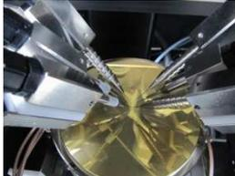
**高電圧プローブ 大電流プローブ**
