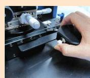
ステージ移動ノブについている移動用スイッチにより、自在にステージをXYに移動させることができます。範囲はXY共に各チャックサイズ以上となります。
